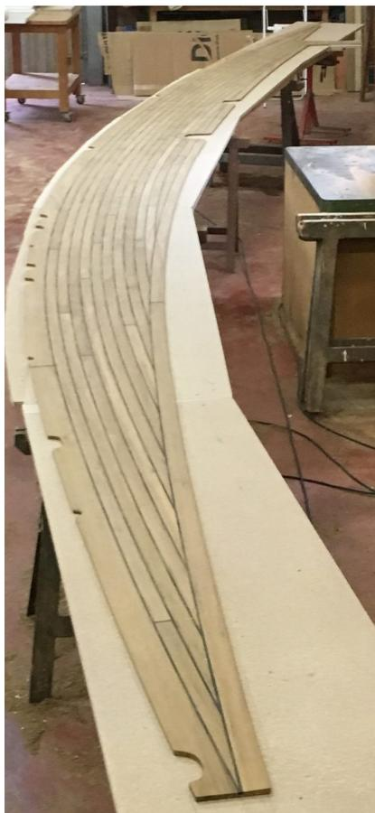
Disponemos de equipos de **medición digital** así como software de diseño 3D, lo cual nos permite realizar un diseño de la cubierta en el ordenador previo a la fabricación.
