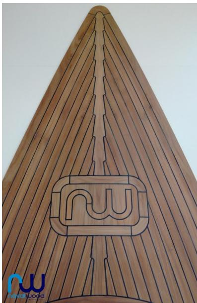
Realizamos íntegramente toda la fabricación, desde la adquisición de la teka, diseño de la cubierta, mecanizado de la madera, ensamblaje de las tablillas y calafateado de juntas, elaborando un kit fácilmente instalable sobre la cubierta de la embarcación.
